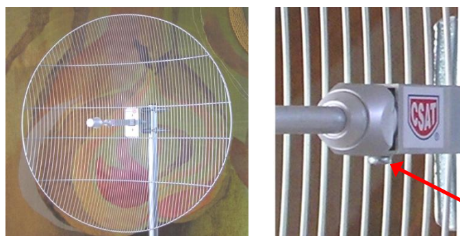
Obr.5 Správne skompletovanie WLAN antény pre vertikálnu polarizáciu
